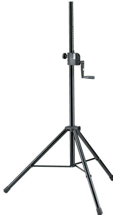
Hochwertiges Boxenstativ aus Stahl mit Kunststoffschellen für den professionellen Einsatz. Die stufenlose Höhenverstellung erfolgt bequem und sicher mittels Kurbel und Drucktaste, die einen unkontrollierten Rücklauf verhindert. Eine zusätzliche Sicherungsschraube sorgt für sicheren Halt. Auszugsrohr-Ø 35 mm, passend für Boxen sowie Leuchentraversen durch eingepresste Gewindebuchse M10.
