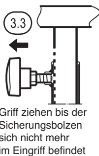
Griff gezogen halten und das Fußrohr ein- bzw. ausfahren
