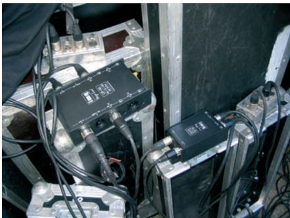
„Helfer“ von IMG Stage Line im Live-Einsatz – LSP-102 (Splitter) und FGA-202 (Line-Übertrager) beim galvanischen Trennen zweier Audio-Ringleitungen
