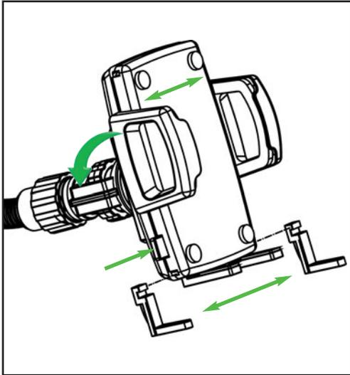
Die Auflagebügel werden seitlich aus dem Smartphone-Halter geschoben. Aus den zwei verschiedenen Auflagebügeln, die für sich am besten geeigneten auswählen und in die dafür vorgesehene Nut schieben. Durch Drücken des Knopfes an der Seite, fahren die seitlichen Anschläge auseinander. Durch die Verstellung am Schwenkgelenk kann der Halter in die gewünschte Position gebracht werden. Hierzu die Klemmscheibe lösen, Halter in gewünschte Position bringen und Klemmscheibe wieder andrehen.
