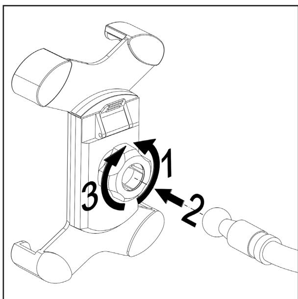
1 Die Klemmmutter am Smartphone-Halter in Richtung UNLOCK so weit öffnen, bis der Kugeladapter **2** mit leichtem Druck in den Smartphone-Halter einschnappt. **3** Klemmmutter in Richtung LOCK handfest anziehen.
