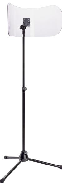
Mit diesem neu entwickelten Stativ können Sie Ihren Beitrag zur EU-Lärmschutzrichtlinie für Orchester leisten. Der gewölbte Acrylglasschirm schützt den Orchestermusiker vor dem Schall des Hintermannes. Das Stativ kann zudem beidseitig verwendet werden, je nach Anwendungsfall. Die stabile Stahlfußkonstruktion gewährleistet einen sicheren und langlebigen Einsatz. Der Schirm kann durch die praktische Prismenführung einfach und schnell auf das Unterteil aufgesteckt werden.
