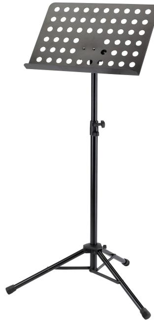
Pulverbeschichtetes gelochtes Notenpult aus Stahl mit Verbindungselementen aus Kunststoff. Die Notenpultplatte kann mit einem praktischen und bedienerfreundlichen Schnellverschluss einfach und schnell montiert und abgenommen werden. Eine große handliche Flügelmutter erleichtert das Fixieren der Schrägstellung. Die stufenlose Höhenverstellung erfolgt über eine oberflächenschonende Spannhülse.
