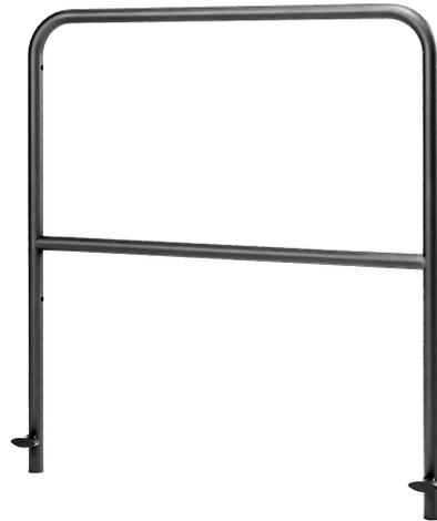
Stabiles Geländer aus pulverbeschichtetem Stahlrohr für Dirigentenpodest 11990. Das Geländer wird einfach aufgesteckt und mit den beigefügten Klemmschrauben gesichert. Zwei Aufsteckadapter sind im Lieferumfang enthalten.
