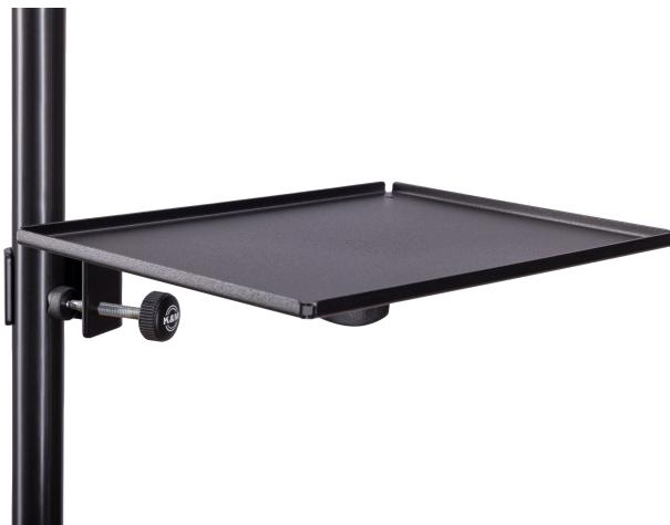
Praktische Ablageplatte aus Stahl zum Anklemmen an Rohrdurchmesser bis 30 mm. Abmessungen 230 x 170 mm, ausgestattet mit einer robusten Struktur-Beschichtung.
