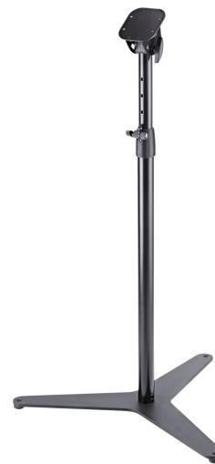
Stabiles Unterteil zur Kombination mit verschiedenen Dirigentenpultplatten. Der schwere flache Metallsockel und die besonders starke Rohrkombination sorgen für beste Standsicherheit. Die Höhenverstellung erfolgt in 40 mm Schritten und wird mit einem Metallhebel sicher fixiert. Die Pulthöhe reicht von 840 bis 1400 mm. Passend für die K&M Dirigentenpultplatte 12332/12333, 12334/12335 und 12338 sowie Partiturlagen 13236/12337.
