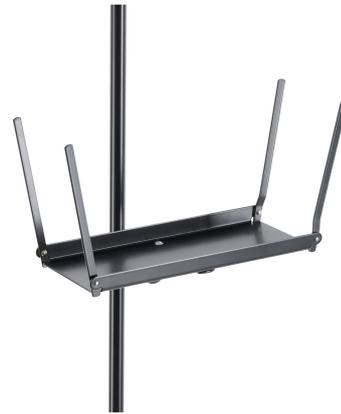
Klassische Ablage für Notenblätter, Hefte und Bücher, zum Befestigen an Notenpulten und anderen Stativen, mit einem Rohrdurchmesser bis zu 30 mm. Die 350 Gramm leichte Ablage aus Aluminiumblech hat eine Fläche von 90 x 240 mm und einklappbare Streben mit einer Höhe von ca. 130 mm. Außerdem punktet die Ablage mit einer strapazierfähigen Pulverbeschichtung und einer oberflächenschonenden Klemmung.
