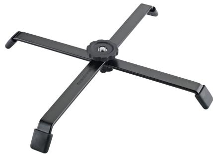
Der robuste Kreuzfuß garantiert einen stabilen Stand für Bodenscheinwerfer. Zum Transport lässt er sich im Handumdrehen flach und platzsparend zusammen klappen. Zusätzliches Werkzeug wird nicht benötigt. Die Endkappen aus Gummi verhindern ein Verkratzen des Bodens. Der Scheinwerfer mit Bügel wird einfach und schnell durch eine handliche Sterngriffmutter auf dem Gewindebolzen M10 befestigt.
