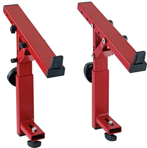
Aufsatz für 3. Ebene bei den Keyboard Ständern »Omega-E« 18800, »Omega« 18810 und »Omega Pro« 18820. Der Aufsatz lässt sich einfach und schnell durch einen Rast- und Klemmknopf auf die gewünschte Höhe positionieren. Zudem sind Tiefe und Neigung in verschiedenen Positionen einstellbar. Dieser Aufsatz kann nur in Verbindung mit dem Aufsatz 18811 verwendet werden. Ein gummierter Anschlag sorgt für die nötige Sicherheit und verhindert ein Abrutschen des Keyboards.
