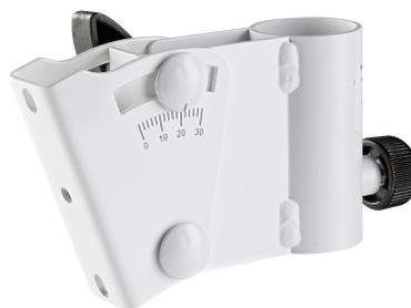
Mit dem Stativadapter können Lautsprecher oder Tonsäulen ohne eingebauten Flansch an Boxenstativen oder Wandhaltern befestigt werden. Die Aufnahme passt für alle Stative mit einem Rohrdurchmesser von 35 mm. Der Adapter kann in der Neigung bis zu 30° eingestellt und außerdem dank der Klemmschraube stufenlos in der Höhe befestigt werden. Zur einfachen Montage wird die Schwenkaufnahme vorab an der Tonsäule befestigt und danach bequem in die Halterung eingesetzt.
