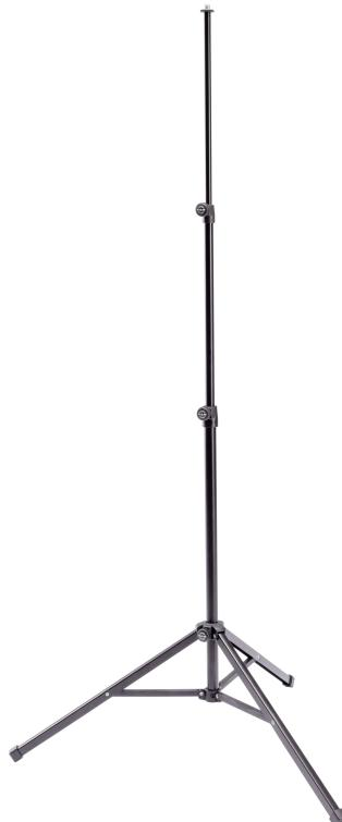
Leichtes, klappbares Stativ, insbesondere zur Aufnahme von Tablet-PC-Haltern aber auch für weiteres Equipment mit passendem Anschlussgewinde (Mikrofone, Kugelgelenke). Das zweifach ausziehbare Stativ ist robust und standsicher und erreicht eine Höhe von 630 bis 1.450 mm. Zusammengelegt misst es nur 570 mm, bei einem Gesamtgewicht von 900 Gramm.
