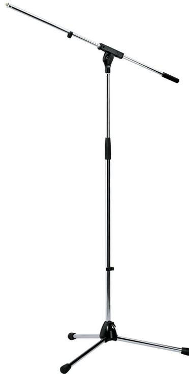
Modernes Pendant zum 210/2, bestehend aus Rohrkombination und Schwenkarm. Durch einen kompakten Zink-Druckguss-Sockel und breiter Fußauflage bietet der 210/6 die gleiche Stabilität und Zuverlässigkeit wie der Klassiker 210/2. Das Vierkant-Schwenkgelenk ist mit einer handlichen Flügelmutter versehen. Die Füße sind umklappbar.
