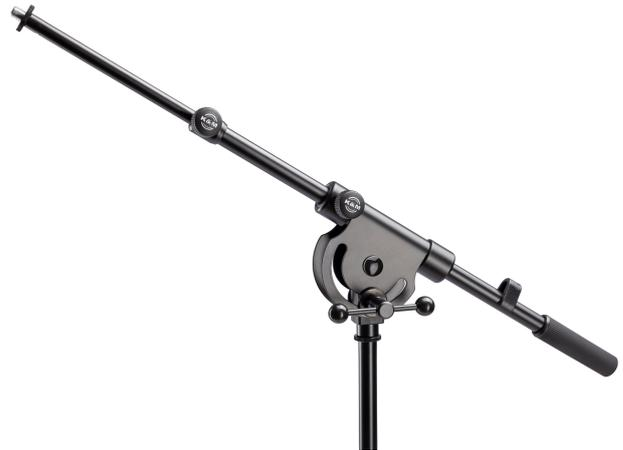
Ausziehbarer Schwenkarm mit 3/8" Mikrofondgewindeanschluss. Die stabile Rohrkomination kann in der Gesamtlänge zwischen 420 und 730 mm positioniert werden. Das speziell konzipiert Schwenkgelenk, mit dem weltweit bewährten Knebel, bietet selbst bei schweren Studio-Mikrofonen eine hervorragende Stabilität und hält auch noch nach Stunden seine eingestellte Position.
