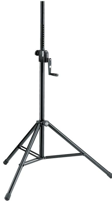
Hochwertiges Boxenstativ aus Stahl mit Zinkdruckgusschellen für den professionellen Einsatz. Die stufenlose Höhenverstellung erfolgt bequem und sicher mittels Kurbel und Drucktaste, die einen unkontrollierten Rücklauf verhindert. Eine zusätzliche Sicherungsschraube sorgt für sicheren Halt. Auszugsrohr-Ø 35 mm, passend für Boxen sowie Leuchtentraversen durch eingepresste Gewindebuchse M10.
