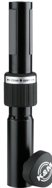
Aufsteckbar auf Boxenstative mit Rohr-Ø 35 mm, arretierbar mittels Klemmschraube. Mit integriertem, patentiertem Spreizdorn für festen, spielfreien und fixierbaren Sitz der Box. Die Spreizbacken aus Kunststoff sorgen für eine resonanzarme Verbindung zwischen Box und Stativ.
