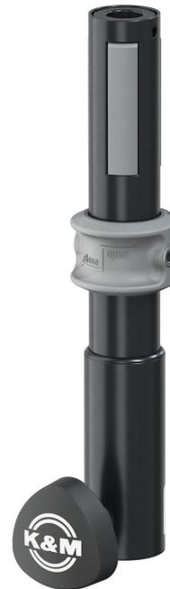
Sinnvolle Erweiterung für alle gängigen Boxenstative mit Rohr-ø 35 mm. Die innovative Adapterhülse wird einfach aufgesteckt und mittels Klemmschraube fixiert. Ein patentierter Spreizdorn mit Schnellverschluß gewährleistet einen festen und vibrationsfreien Sitz der Lautsprecherbox. Die Spreizbacken aus Kunststoff sorgen für eine resonanzarme Verbindung zwischen Box und Stativ.
