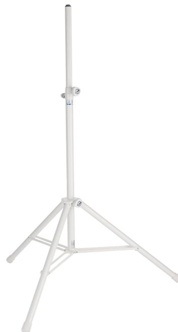
Das weltweit anerkannte Boxenstativ ? robust und langlebig. Alle Spannschellen sind aus hochwertigem Zinkdruckguss. Die Fußkonstruktion und die großen fest fixierten Parkettschoner sorgen für Standsicherheit und Stabilität. Zusätzliche Merkmale sind eine Auszugssicherung, der StoÙdämpfer im Grundrohr und eine komfortable Höhenverstellung mit Rastbolzen. Eine zusätzliche Aufsteckhilfe erleichtert die Boxenmontage.
