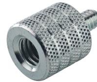
Reduziergewinde Außendurchmesser 18 mm. Innengewinde 3/8". Außengewinde 1/4".
