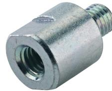
Reduziergewinde Außendurchmesser 20 mm. Innengewinde 3/8". Außengewinde M 10 mm. Mit Schlüsselflächen SW 17.
