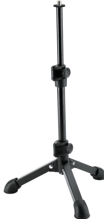
Das telekopierbare Tischstativ mit dem 3/8" Gewindeanschluss ist vielseitig einsetzbar. So können etwa Handheldrecorder oder sogar Fotoapparate befestigt werden. Die Höhe kann durch die formschönen Spannhebel zwischen 230 und 400 mm individuell eingestellt werden. Das leichte Dreibeinstativ mit den einklappbaren Füßen ist gut für den mobilen Einsatz geeignet. Die robusten Parkettschoner sorgen für einen sicheren Stand und reduzieren unerwünschte Übertragungsgeräusche.
