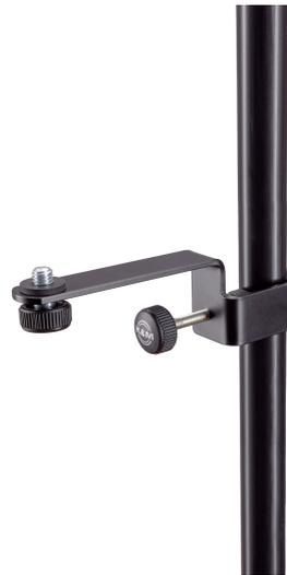
Stabile Mikrofon-Halteschiene, aus pulverbeschichtetem Stahl, mit 3/8" Gewindeanschluss zum Anklempfen an Rohrdurchmesser bis 30 mm.
