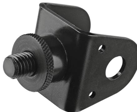
Der Adapter dient als Zubehör für die Bildschirm-Halter 23870, 23873, 23875 und 23878. Mit Hilfe des Adapters können verschiedene Produkte, die mit einem 3/8" Anschlussgewinde ausgestattet sind, aufgenommen werden, wie z.B. Tablet und Smartphone-Halter, Mikrofonklammer etc. Ein Innensechskantschlüssel SW5 ist im Lieferumfang enthalten.
