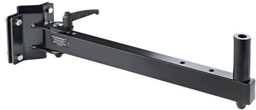
Boxenhalterung für vertikale Traversensysteme. Die Rohrschelle ist geeignet für Durchmesser von 45 - 55 mm. Passend für Lautsprecherboxen mit Flanschbuchsen-Aufnahme von 36 mm. Max. Belastung 50 kg. Stufenlos schwenkbar bis 240°. Lautsprecherabstand in 3 Stufen wählbar.
