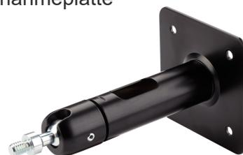
Der praktische Wand- und Deckenhalter für kleinere Lautsprecherboxen wurde in der 2017er Version im Detail überarbeitet. Neu hinzugekommen ist ein Kabelauslass, der jetzt eine interne Kabelführung für verdeckte Installationen ermöglicht. Dank zweier Sonder-Gewindestifte und des mitgelieferten Sechskantschraubendrehers, kann das flexible Kugelgelenk exakt positioniert und fixiert werden. Die Tragfähigkeit steigt somit auf 10 kg. Der Wandabstand wurde auf 160 mm verringert.
