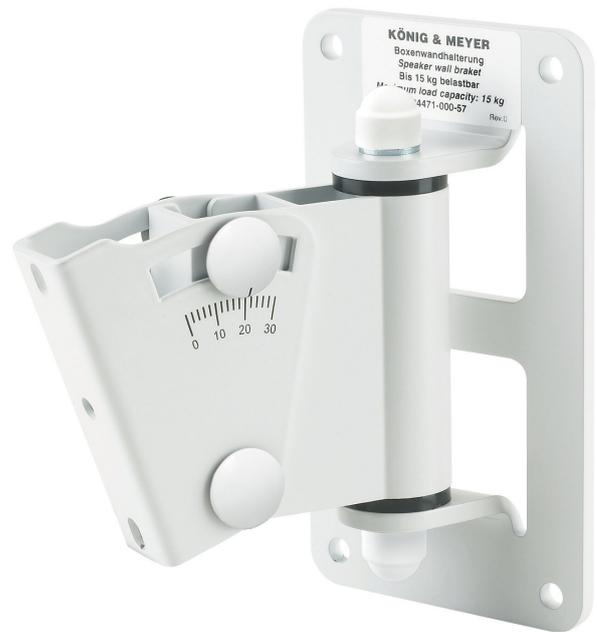
Vielseitig einsetzbare Wandhalterung für Lautsprecherboxen. Die montierte Box kann seitlich geschwenkt und bis 30° geneigt werden. Einfache Montage durch praktisches Einhängen und Verschrauben.
