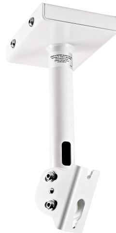
Robuste und zweckmäßige Lautsprecher Deckenhalterung mit 250 mm Abstand und interner Kabelführung. Der Schwenkbereich beträgt +/-45 °. In der Neigung sind Einstellungen von 0 bis 45° stufenlos möglich. Die Klemmhalterung ist für Lautsprecherboxen mit vertikalem Befestigungslochbild von 70 bis 76,2 mm ausgelegt. Für weitere Befestigungsmöglichkeiten sind separate Adapterplatten erhältlich. Eine Montageplatte mit seitlicher und zentraler Kabeldurchführung erleichtert die Befestigung an der Decke.
