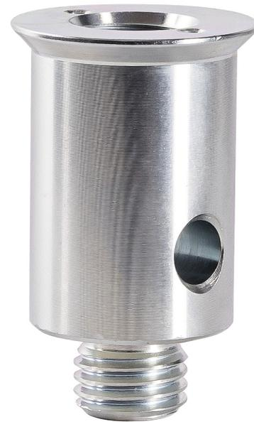
Praktischer Adapterbolzen aus Metall, passend für die Flanschbuchsen von Penn Elcom mit Durchmesser 35 mm und zusätzlichem Gewinde M20. Der Adapter wird benötigt, um teleskopierbare Distanzstangen mit M20 in dieser Flanschbuchse einsetzen zu können. Die abgestimmte Länge von 52 mm mit dem zusätzlichen Bund sorgt für vibrationsfreien und formschlüssigen Sitz.
