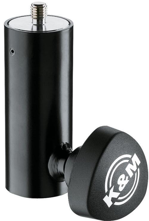
Passend für alle K&M-Boxenstative- $\varnothing$  35 mm. Mit Gewindezapfen M10 x 12 mm und großer Klemmschraube zum Arretieren am Stativ.
