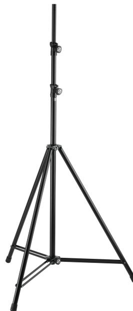
Bis über 4 m ausziehbar ist dieses Leuchtenstativ für den professionellen Einsatz. Die neuen Spannschellen aus Zinkdruckguss sowie die größeren Fußrohre aus Stahl verleihen diesem Topstativ noch mehr Sicherheit. Die stufenlose, oberflächenschonende Höhenverstellung kann zusätzlich durch 2 Sicherungsringe verstärkt werden. Über die integrierte Gewindebuchse M10 lassen sich verschiedene Traversen befestigen.
