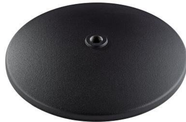
Extra schwerer Graugusssockel mit 300 mm Durchmesser. Der Gewindeanschluss M20 x 1,25 mm Feingewinde ist kompatibel für alle K&M Mikrofonständer mit Rundsockel. Ein umlaufender Gummiring dämpft den Trittschall und reduziert unerwünschte Übertragungsgeräusche. Pulverbeschichtet schwarz Struktur.
