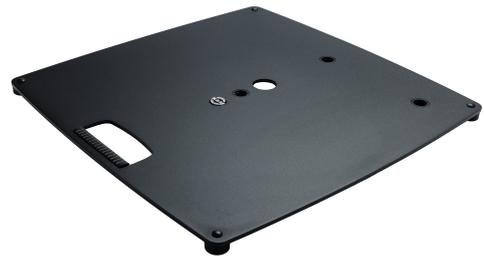
Praktische und solide Sockelplatte für alle gängigen Distanzrohre und Rohrkombinationen mit Gewindebolzen M20. Je nach Bedarf gibt es drei Möglichkeiten die Standsäule zu positionieren. Neben der zentrischen und außermittigen Position bietet sich die Möglichkeit, die Rohrkombination auch in der Ecke zu befestigen. Ein ergonomischer Tragegriff, eine Kabeldurchführung sowie vier stabile Gummifüße sind weitere nützliche Features. Die Abmessungen betragen 550 x 550 mm, bei einem Gewicht von 13,5 kg.
