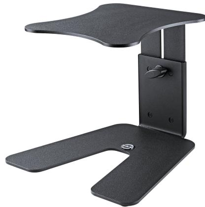
Formschönes Tischstativ für Studiomonitore und Lautsprecher. Die Höhenverstellung erfolgt stufenlos zwischen 167 und 254 mm. Jeweils 4 Gummi-Auflagen für Boden? und Auflageplatte sorgen für rutschfesten Stand und Entkopplung. Die max. Belastung wird mit 15 kg empfohlen. Die Auflagefläche misst 230 x 250 mm.
