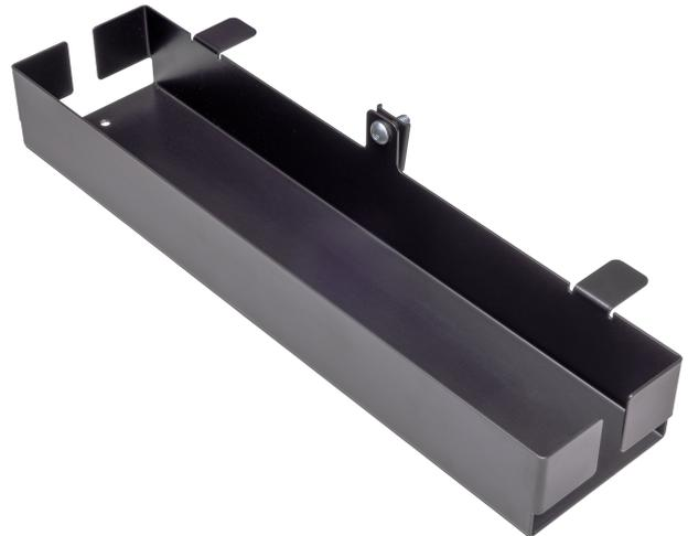
Die praktische Box wird in Bodennähe am Querrohr des Stativs für Confidence-Monitore angebracht und dient der Aufnahme von Steckdosenleisten und der ordentlichen Verstaung überlanger Kabel. Die solide Konstruktion aus robustem Stahlblech hat seitliche Freimachungen, die genügend Platz zur komfortablen Kabelführung bieten. Die Abmessungen betragen 437 x 100 x 60 mm.
