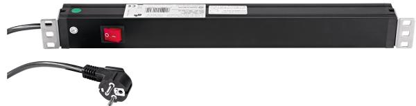
1 HE Stromverteilereinheit für 19" Schränke und Racks. Die Steckdosenleiste hat einen Netzschalter auf der Frontseite und 7 Stück Steckdosen auf der Rückseite. Die Ausgangsleistung beträgt 3500 Watt. Dank der beidseitig abnehmbaren Montagewinkel kann die Steckdosenleiste in verschiedene Richtungen installiert werden.
