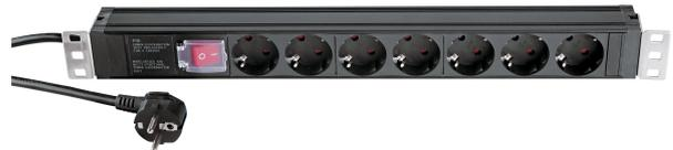
1 HE Stromverteilereinheit für 19" Schränke und Racks. Die Steckdosenleiste hat einen Netzschalter und 7 Stück Steckdosen auf der Frontseite. Die Ausgangsleistung beträgt 3500 Watt. Dank der beidseitig abnehmbaren Montagewinkel kann die Steckdosenleiste in verschiedene Richtungen installiert werden.
