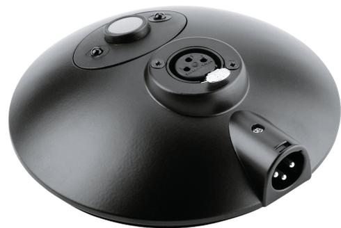
Formschöner, kompakter Zinkdruckguss-Sockel. 3-polige XLR-Anschlüsse (Stecker/Buchse), kpl. verdrahtet, knackfreies Schalten, mit Phantomspeisung-Kontrollleuchte, mit Schalter (grau), 2 Dioden zeigen Betriebszustand an (Spannung - Mikro an/aus).
