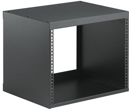
Stabiles Rack aus Stahlblech mit 19"-Rackschienen an der Front- und Rückseite. 8 HE, 429 mm tief. Mit schwarzem Strukturlack pulverbeschichtet.
