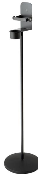
Rundsockel mit ø 275 mm und umlaufendem Bodenschutz aus Gummi. Stahlrohr pulverbeschichtet. Höhe 1.020 mm. Abmessungen Flaschenhalter Innen 102 x 65 bis 102 mm. Mit Klemmbügel zum Fixieren der Desinfektionsflasche. Die Kunststoff-Tropfschale kann zur Reinigung entnommen werden. Bitte beachten Sie, dass es sich bei dem Stativ um kein medizinisch zertifiziertes Produkt handelt. Desinfektionsmittel nicht im Lieferumfang enthalten.
