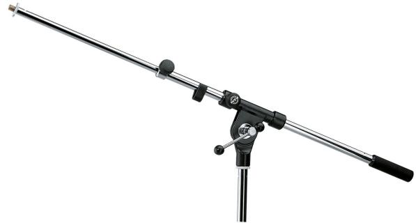
Klassische ausziehbare Rohrkombination mit 3/8" Anschlussgewinde, Konterscheibe und Griff. Geräuschlos verstell- und neigbar. Sichere Klemmung durch beweglichen Knebel. Kein Verkratzen der Rohroberfläche durch Kunststoffhülsen im Stahlteil.
