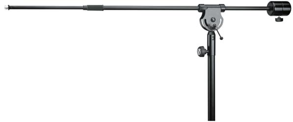
Ausziehbarer Schwenkarm mit 3/8" bzw. 5/8" Mikrofongewindeanschluss. Die stabile Rohrkomination mit den Durchmessern 20 und 15 mm erreicht eine nutzbare Auszugslänge von 1.670 mm. Ein 3 kg schweres Gegengewicht sorgt für die nötige Balance. Dank dem ø 35 mm Stativadapter ist der Schwenkarm mit üblichen Boxen- und Leuchtenstativen kombinierbar.
