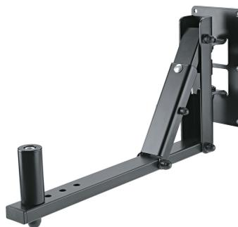
Robuste Boxenwandhalterung für Lautsprecherboxen mit Flanschbuchsen-Aufnahme. Max. empfohlene Belastung 25 kg. Dank der entsprechenden Konstruktion wird die Halterung nahezu komplett vom Lautsprecher verdeckt. Der Lautsprecherabstand zur Wand ist in 4 Stufen wählbar. Der Schwenkbereich ist stufenlos verstellbar und der Neigungswinkel kann in 6 Stufen bis max. 30 ° fixiert werden.
