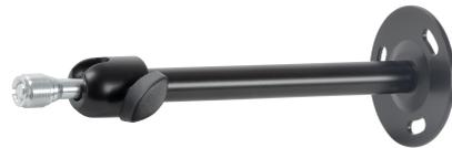
Universeller Wandhalter mit 3/8" bzw. 5/8" Aufnahmebolzen für Mikrofone und Antennen. Dank praktischem Kugelgelenk ist die Halterung 360° schwenk- und 90° neigbar. Die Befestigungsplatte hat einen Durchmesser von 70 mm und der Wandabstand beträgt 205 mm.
