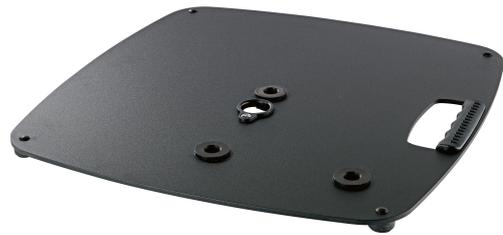
Schwere und solide Sockelplatte für alle gängigen Distanzrohre und Rohrkombinationen mit Gewindebolzen M20. Je nach Bedarf gibt es drei Möglichkeiten die Standsäule zu positionieren. Neben der zentrischen und außermittigen Position bietet sich die Möglichkeit die Rohrkombination auch in der Ecke zu befestigen. Ein praktischer Tragegriff, eine Kabeldurchführung sowie vier stabile FüÙe mit Filzüberzug sind weitere nützliche Features.
