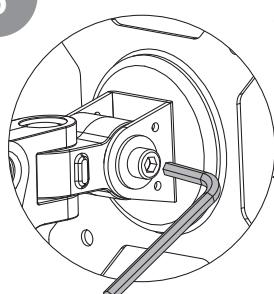
Verwenden Sie einen Innensechskantschlüssel, zur Einstellung der Beweglichkeit. Drehen Sie gegen den Uhrzeigersinn, um sie zu verringern und im Uhrzeigersinn, um sie zu erhöhen.
