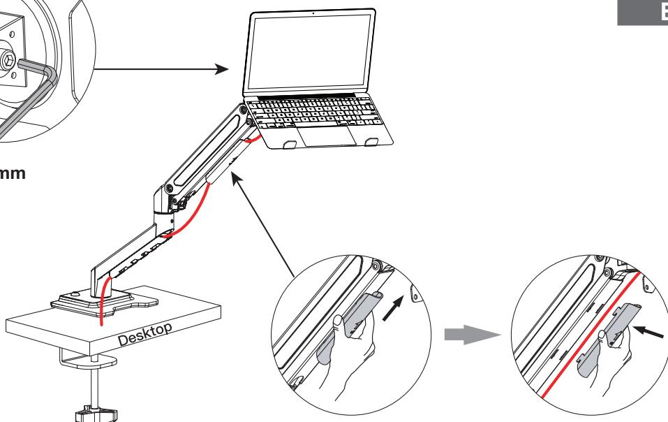
Kabel in Kabelabdeckungen einführen. An den Armgelenken genügend Kabelspielraum lassen, um eine vollständige Einstellung zu ermöglichen.
